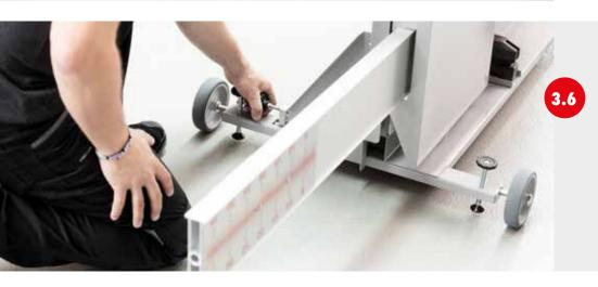
Leichte Feineinstellung (Ausrichtung der Parallelität zur Fahrzeughinterachse) mit Sterngriffschraube am Fahrwagen möglich.
