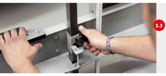
Einstellen des Laserträgers für die Radarkalibrierung (bis zu 1,0 m).
