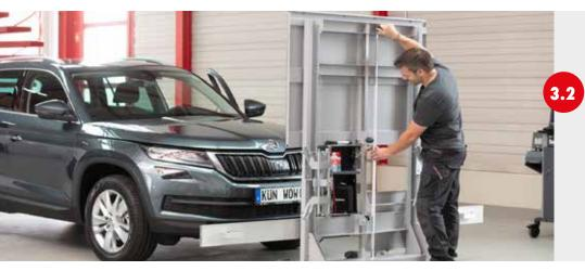
Einstellen des Kalibriertafelhalters zur Kamerakalibrierung mittels Federentlastung. Bis 1,85 m möglich und auch für Transporter geeignet.
