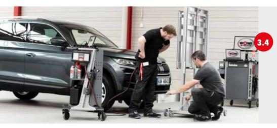
Rangierräder mit Hilfe des Lifterhebels Anheben und Absenken, damit die leichte Ausrichtung parallel zum Fahrzeug möglich ist.
