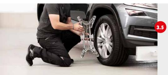
Das schnelle Anbringen der selbstzentrierenden Radklammer auf 11 – 25 Zollfelgen.
