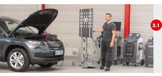
Ein mobiler Einsatz des Systems ist durch den Fahrwagen mit Rangiereinheit möglich.
