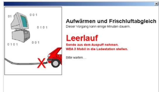
**⚠ ACHTUNG!** Es ist wichtig, dass sich die Abgassonde **nicht** im Auspuff befindet. Der Abgleich wird nicht korrekt durchgeführt, und dies kann während der anschließenden Messungen zu Falschmessungen und Fehlermeldungen führen.
