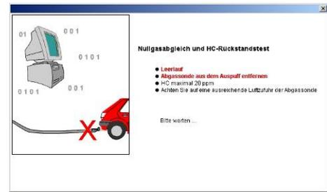
**⚠ ACHTUNG!** Abgase immer mit der Absauganlage absaugen und Räume gut belüften. Während des HC-Rückstandstests entfernen Sie bitte unbedingt die Sonde aus dem Auspuff.
