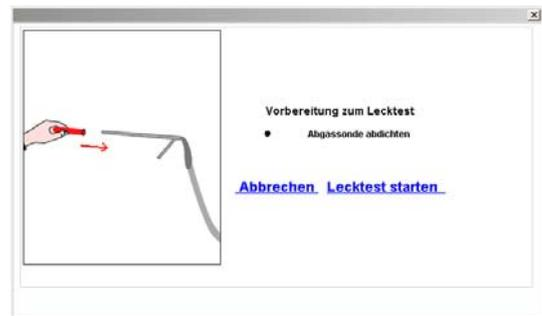
**HINWEIS:** Die Schlauchlänge muss ca. 8m betragen, da das Volumen des Schlauches im Test mitgeprüft wird. Bei Beschädigungen des Schlauches muss dieser komplett bis zum Filter getauscht werden. Eventuelle Gegenstände auf dem Schlauch entfernen. Darauf achten, dass der Schlauch nicht geknickt ist. Filter und Anschlüsse des Schlauches prüfen.
